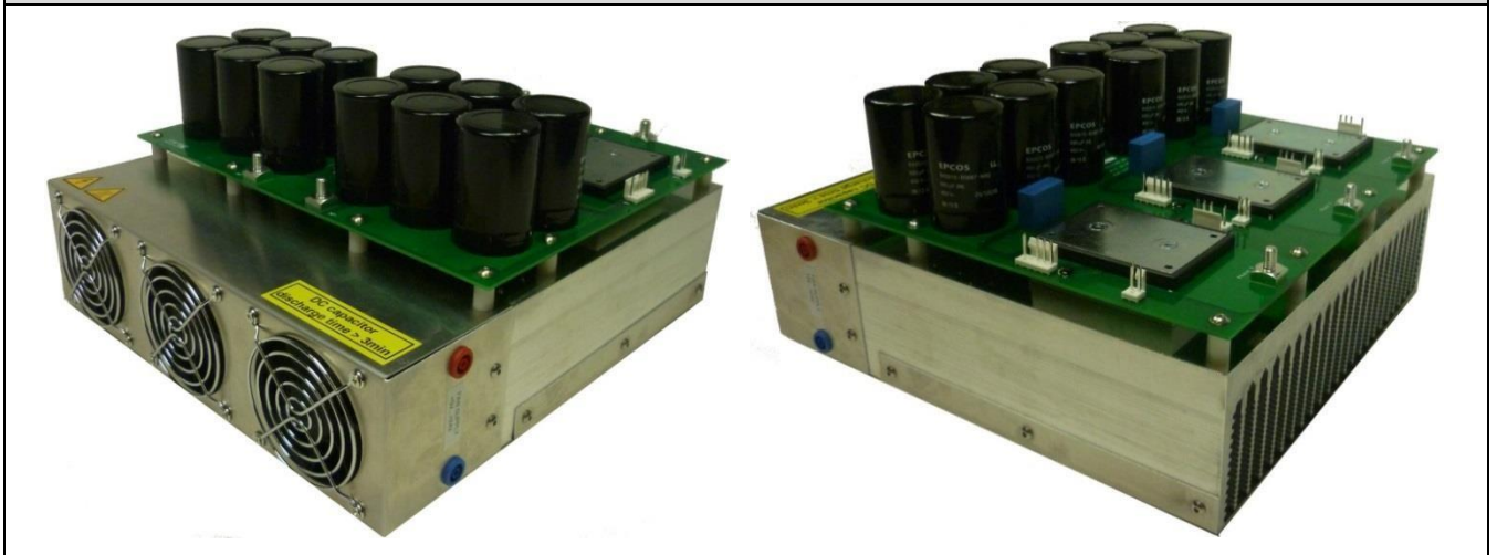
그림 9: 3상 인버터의 DC측면도(좌)와 AC측면도(우)
