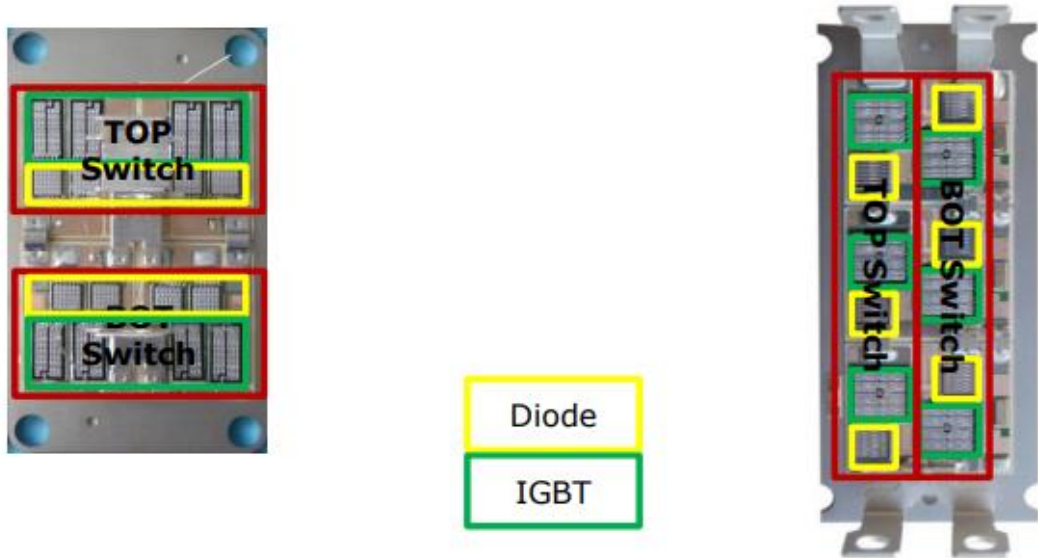
그림 7: 표 4 에 따른 스위치 간 열 커플링의 다양한 상황별 450 A-SEMİTRANS(좌) 및 450 A-SEMİX(우)의 열저항 R_{th(c-s)}
