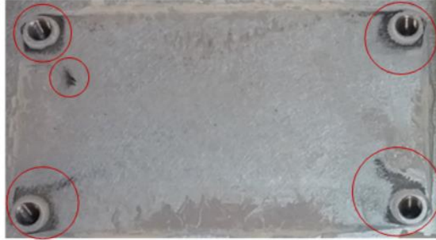
그림 29: 과도한 열사이클로 인한 방열판의 검정 자국
