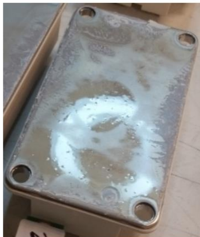
그림 28: 현장 내 고온 작동 후 캐리어 오일과 충전제의 분리를 보여 주는 SEMITRANS 모듈의 하부
