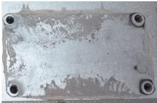
그림 27: 열 사이클 반복 후 펌프아웃 징후를 보이는 SEMITRANS 모듈의 장착 위치
