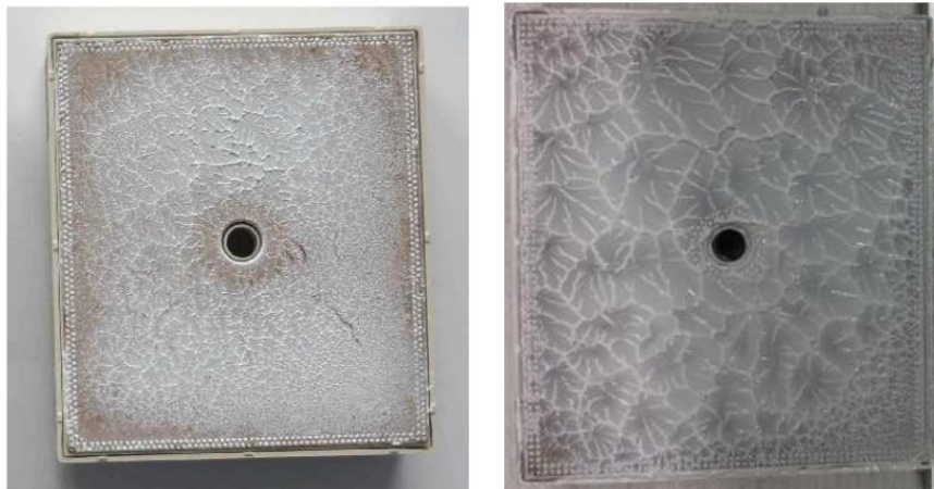
그림 25: 페이스트의 분포(L) 및 과도한 페이스트(R)
