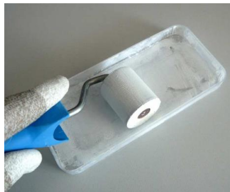
그림 6: 하드 플라스틱 트레이를 사용하여 페이스트를 롤러에 장착하는 공정
