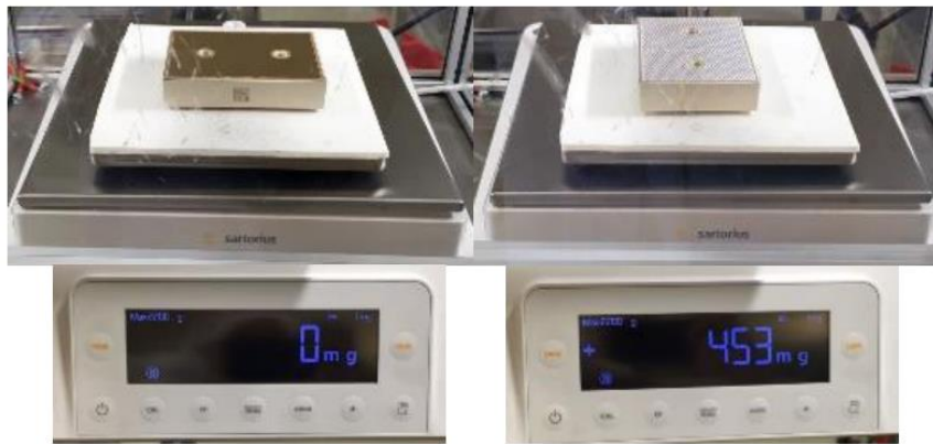
그림 23: 페이스트 전(L)과 후(R) 모듈 무게 측정
